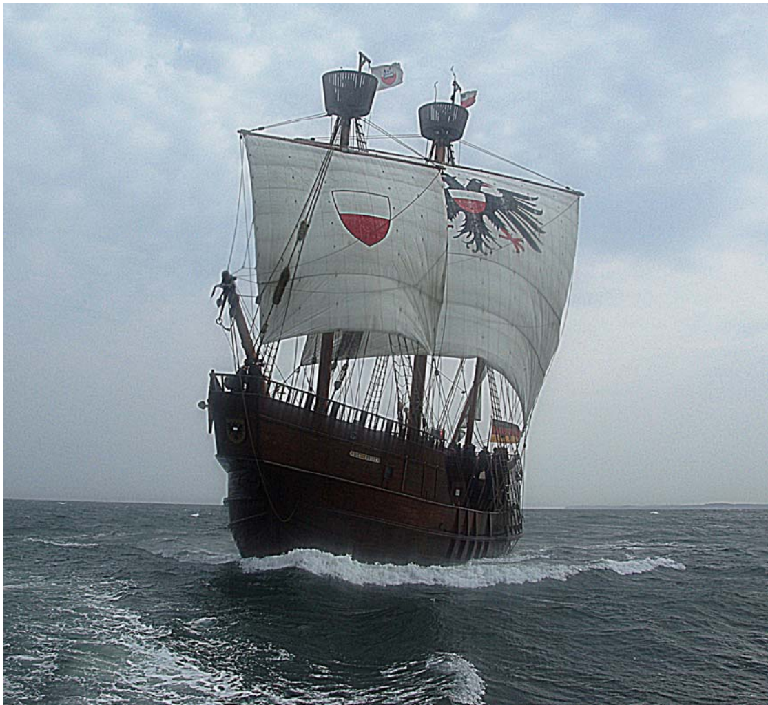
Länge 35,9 m (Lüa), 30,12 m (Lpp) • Breite 9,3 m • Tiefgang max. 2,86 m • Verdrängung 198 to • Anzahl Masten 3 • Anzahl Segel 3 • Segelfläche 276 m 2
